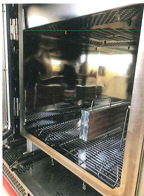
Obrázek č. 1 - Vzorek č. 412110170/01 v emisní komoře
